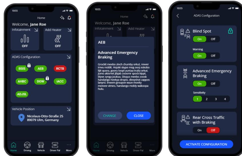
**IVECO ON Plus** erweitert die Funktionen von **IVECO ON Access** und bietet zusätzliche Möglichkeiten zur Fahrzeugsteuerung und -überwachung. Kunden können die **Fahrerassistenzsysteme** des Fahrzeugs steuern, sofern die erforderlichen Fahrzeugsensoren verfügbar sind. Zudem ermöglicht es die **Kontrolle der Fahrzeugposition**, die alle 15 Minuten aktualisiert wird, um die Fahrzeugverlagerung in Echtzeit nachzuvollziehen und eine präzise Flottenverfolgung zu gewährleisten.
